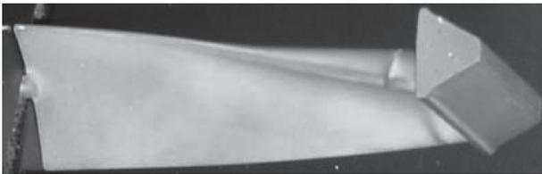
Figure 10 : Exemple d'une aube de turbine de moteur d'hélicoptère (échelle  $\frac{1}{2}$  environ) équipée d'un revêtement fait d'un alliage aperiodique. Ce matériau est aussi peu conducteur de la chaleur que la zircone. Il protège l'alliage dont est fait l'aube d'une trop forte élévation de température et prolonge ainsi sa durée
