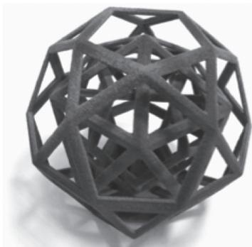
Figure 11 : Cette pièce, de 7 cm de diamètre environ, ne peut pas être réalisée par des techniques d'usinage classiques. Elle est par contre relativement aisée à obtenir par prototypage rapide à partir d'un mélange de poudres de polymère et d'alliage métallique. Le matériau organique est tout d'abord polymérisé sous l'effet d'un faisceau laser, ce qui laisse une forme solide qui peut être manipu-
