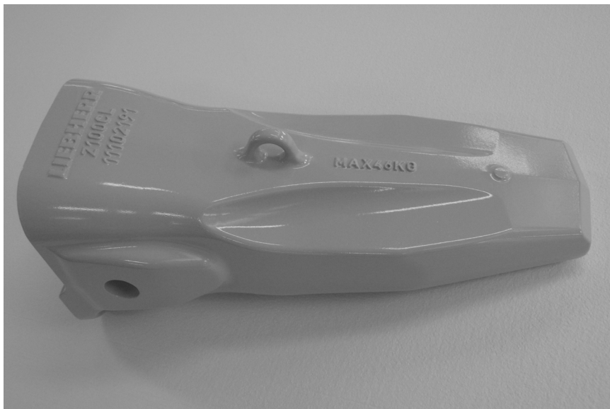
Figure 10. Prototype géométrique par Stratoconception® d'une dent de godet de pelleuse - Application minière pour LIEBHERR – 2013 -
