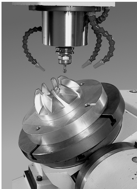
Fig. 2. Exemple de réalisation de pièces sur MOCN 5 axes simultanés (aube de turbine)
