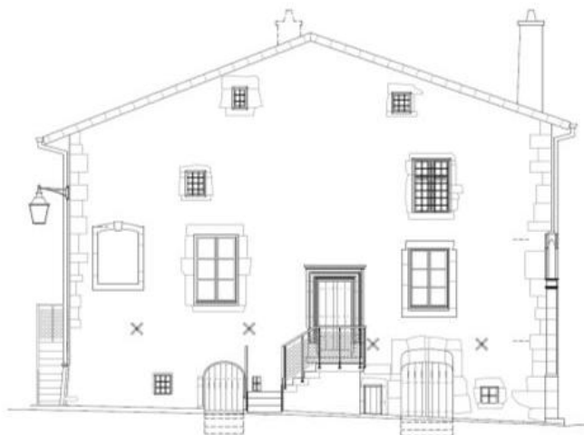
Figure 13- Projet de restauration de la façade principale de la loge de la Vierge [in 1] (Dessin Atelier Grégoire et Camille André - Nancy).
