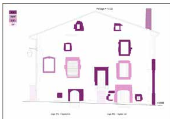
Figure 12- Relevé et datation des ouvertures de la façade principale de la Loge de la Vierge [in 1].
